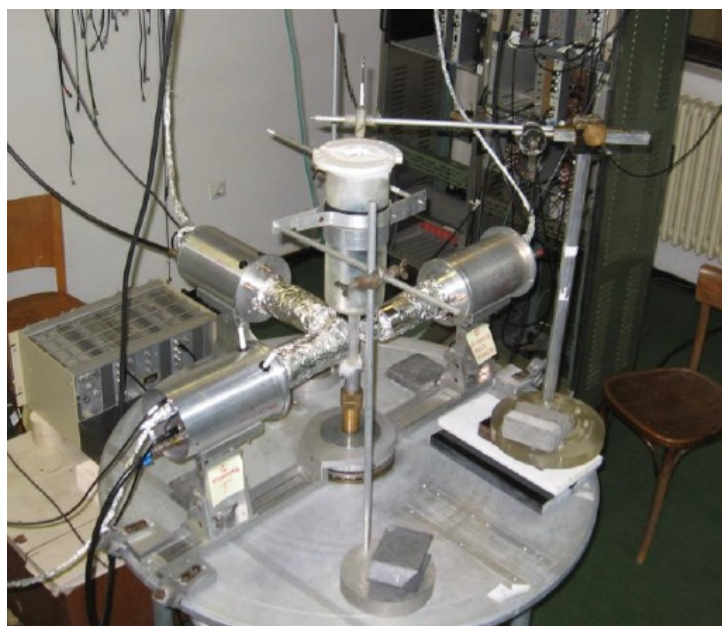
Slika 10. PAC aparatura sa uzorkom smeštenim u Djuarovom sudu
